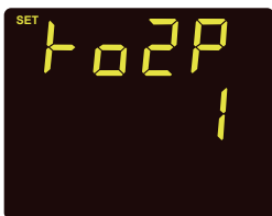
Fig 3-33 RO2 Alarm Parameter Setting
