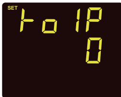
Fig 3-27 RO1 Alarm Parameter Setting
